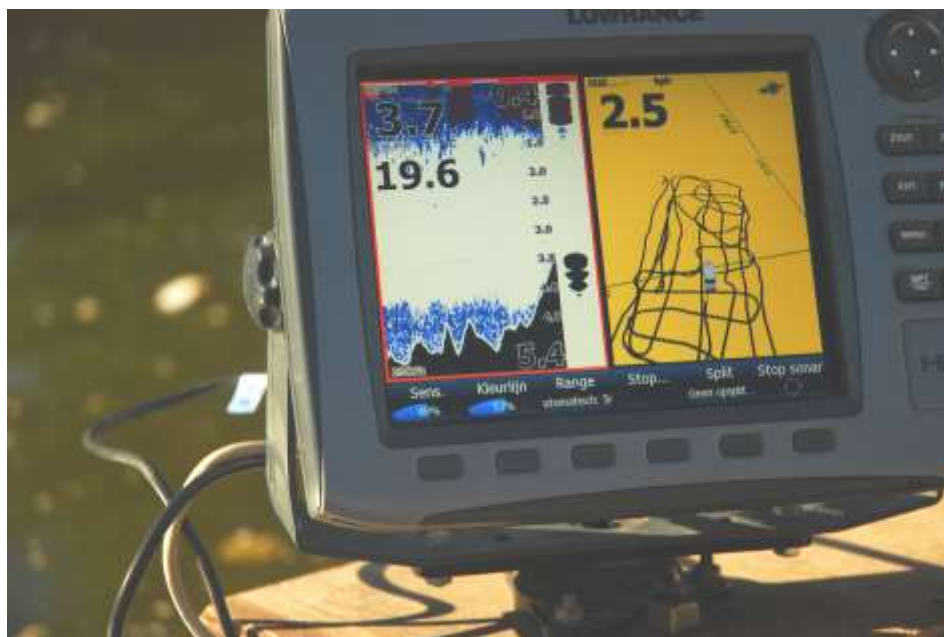
De fishfinder met links het sonarscherm met diepteverloop (3,7 m is de actuele diepte, 19,6 is de watertemperatuur) en op het rechterscherm de afgelegde weg op het water (2,5 is de actuele vaarsnelheid in km/h).
